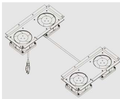
Figura 7 - Ventiladores de teto para rack
